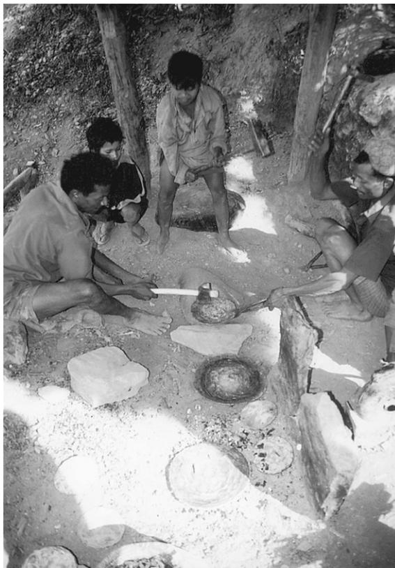
写真4 溶解してできた銅盤 (pāg) を打ち延ばす [カリコット 1999 年]
